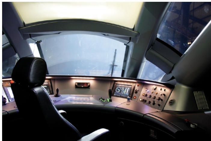
Pulpit maszynisty pociągu AGV (5.02.2008 r.)
