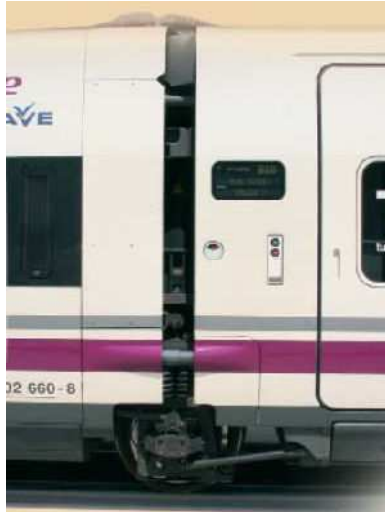
Rys.6. Połączenie wagonów doczepnych systemu Talgo [6].
